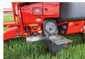
Funil de indução de aço inoxidável de 52 litros, incluindo bico de choque adicional
