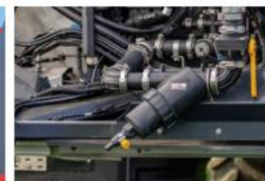
Segundo filtro de pressão no quadro central da barra
